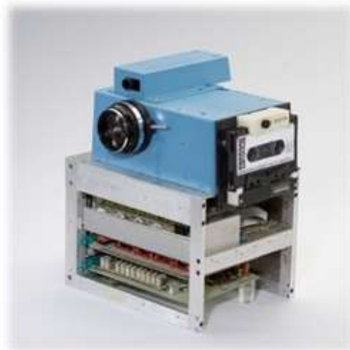
Figura 4. O primeiro protótipo de uma câmera fotográfica digital desenvolvido por Steve Sasson para a Eastman Kodak
